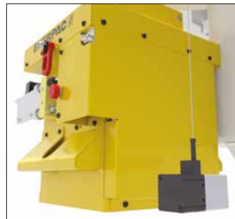
▼ Volitelný kabelový snímač zdvihu poskytuje zpětnou vazbu velikosti zdvihu pro účely řízení čerpadla.
