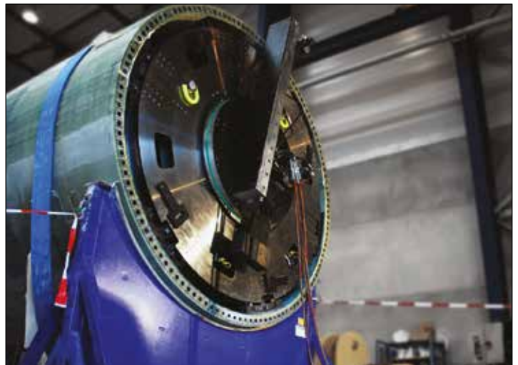
▼ Obrábění kořene listu větrné turbíny s použitím zařízení WP3500.
