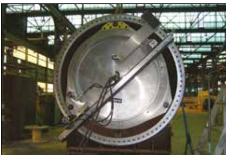
▼ Obrábění tubusu větrné turbíny s použitím zařízení WP4600.
