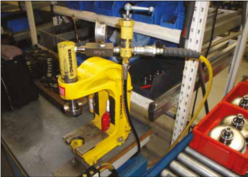
▲ Válec RC308 umiestnený v montážnom lisu A330 poháňaný vzduchovým čerpadlom PATG-Turbo zaisťuje riazené lisovanie ložísk ozubených kol tkalcovských stavů. Lisovací síla je riadená prostredníctvom odpušťačieho ventilu V152.
