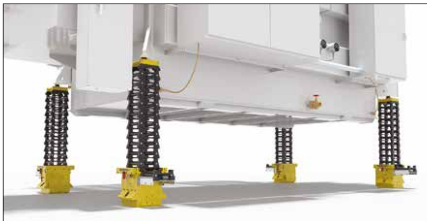
▼ Typická konfigurace se 4 samojistnými blokovými zvedáky Cube Jack a podpěrnými bloky při zdvihání transformátoru (nejsou zobrazeny hydraulické hnací jednotky a hadice).
