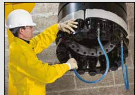
▲ Použití předpínače Multi Stud.
