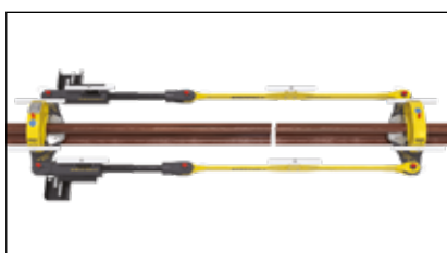
▲ Modulární napínák se silou 70 tun drží kolejnice v neutrální délce během svařování.
