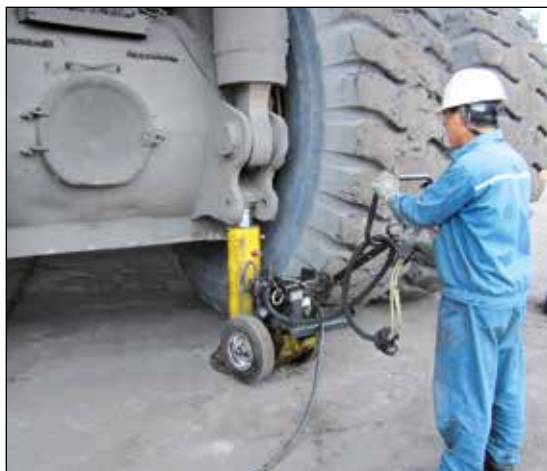
◀ Použití zvedáku Enerpac Pow'r-Riser® v důlním průmyslu pro zvedání těžkého vybavení.
