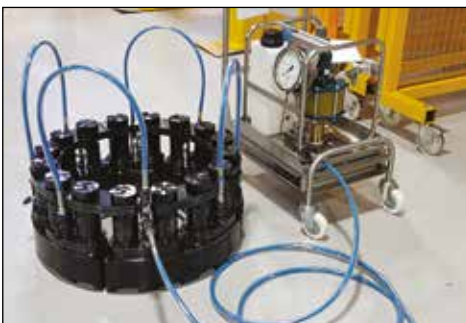
◀ Specializovaný předpínací systém Enerpac Multi Stud Tensioning (MST) umožňuje předpínat všechny svorníky spoje najednou.
