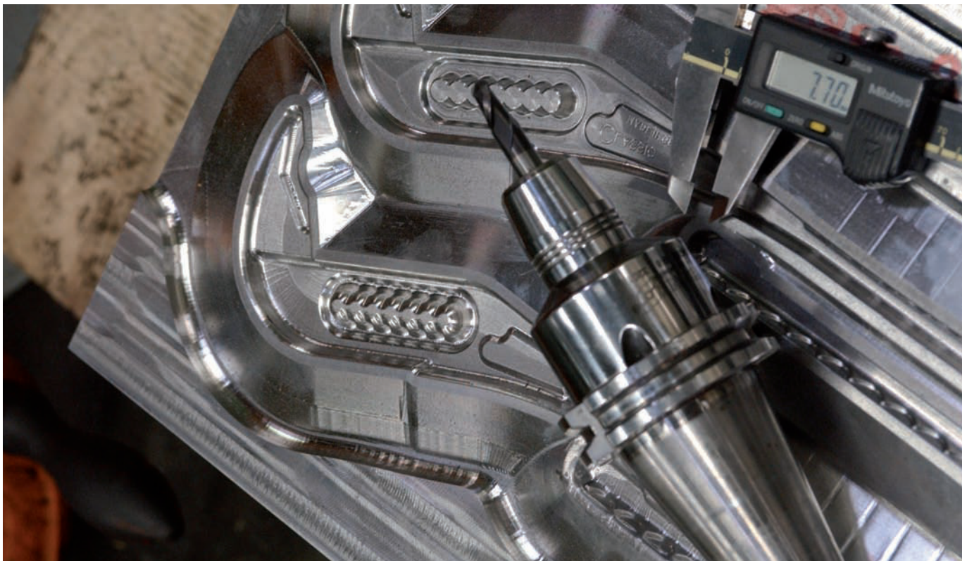
Gesenk für Zangen forging die for cutters
